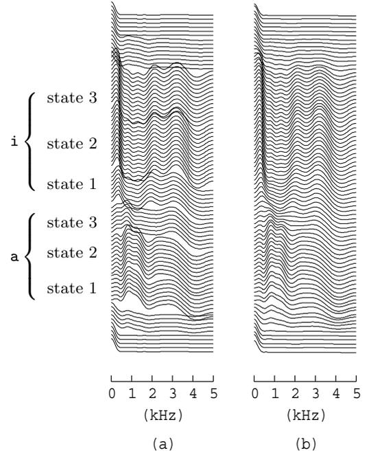
図 4 音素モデル sil, a, i, sil を接続することによりつくられた HMM からのパラメータ生成例. (a) 動的特徴なし, (b) 動的特徴あり.
